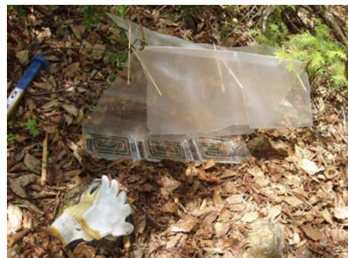
図 2 丸山式 FIT の概略図と写真. 主に A3 クリアファイルを切り開いたもので構成されている. 30%エタノールを固定液とした.
